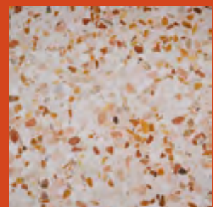
Deco ghiaio: cipria Cemento: bianco Graniglia: 12-16 33% rosso Verona - 33% giallo mori - 33% bianco Carrara
